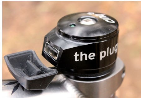
Mit Muskelkraft die Akkus laden, der USB-Lader macht's möglich und befreit von der Steckdose.
