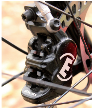
Zuverlässige 4-Kolben Stopper. Bei der Rad-Konfiguration können auch 203 mm Scheiben gewählt werden.
