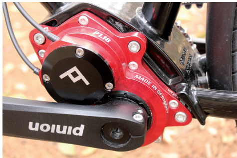
Zentralgetriebe Made in Germany. Die Pinion läuft sehr leise, allenfalls ein leicht mahlen-des Geräusch ist zu hören.
