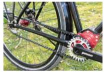
Conti-Riemenantrieb mit Pinion 18-Gang-Getriebe: leise, wartungsarm, fein gestuft.
