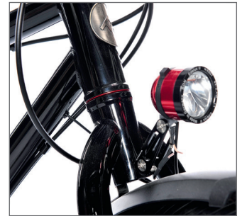
Große Durchmesser bei Steuerrohr und Gabel bringen Steifigkeit.
