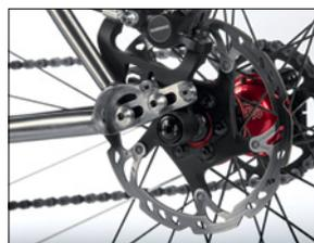
Über die Ausfallenden stellt man die Kettenspannung einmal ein, der Radausbau erfolgt dann wie gewohnt über die Schraubachse.
