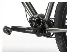
Das Pinion passt nur an speziell vorbereitete Rahmen. Die Steifigkeit des Hoplit ist mit montiertem Getriebe höher als ohne (85 Nm/Grad).
