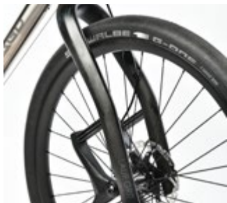
Shimanos Ultegra-Scheibenbremse entschleunigt effektiv. Unten: Die innovative Lauf-Federgabel steigert den Fahrkomfort.
