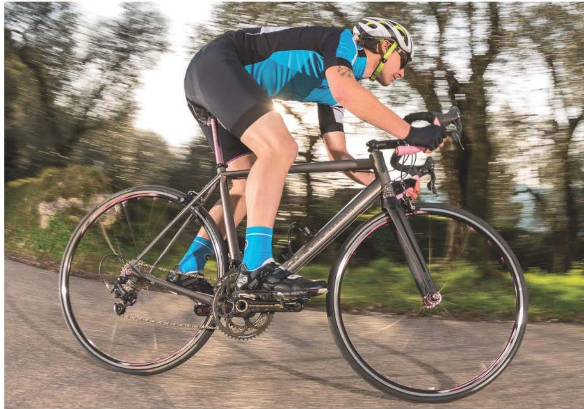
▲ Das stimmige Falkenjagd verbindet klassische Merkmale wie den Tretlagersteg mit modernen Details wie dem PressFit-Gehäuse.
