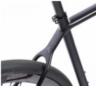
Nobel: Campas Ekar-Kurbel am feinen Parapera-Chassis. Unten: Via Verbindungssteg (wie im Bild) wird ein Heckträger fixiert.
