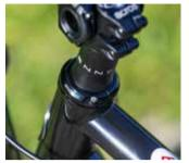
Steife, haltbare Laufräder dank Boost-Nabenstandard. Unten: Unscheinbar, aber sinnvoll: Steuersatz mit Lenkanschlag.
