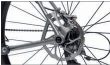
Links: Scheibenbremsaufnahme aus Titan und Steckachsen. Mitte: Die neuen leichten Disc Laufräder kommen von Tune hat. Rechts: Der Vorbau kommt ebenfalls zum Falkenjagd.
