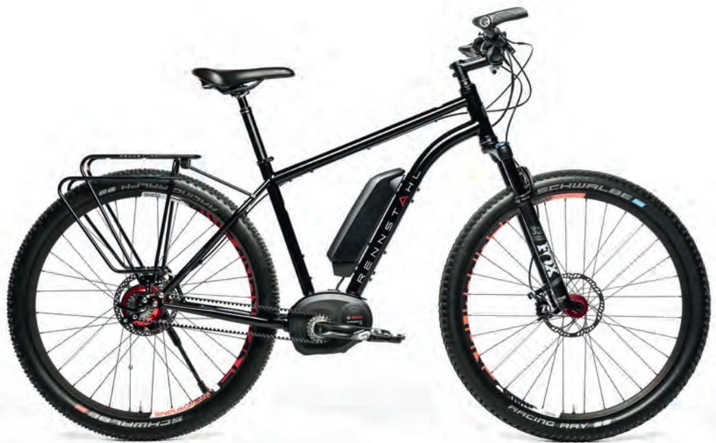
Rohloffs bewährte 14-Gang-Nabenschaltung als E-Variante.
