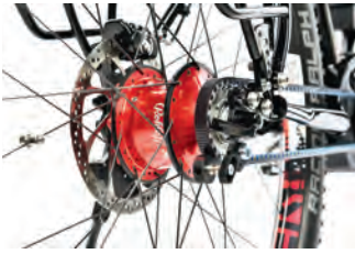
Rohloffs bewährte 14-Gang-Nabenschaltung als E-Variante.
