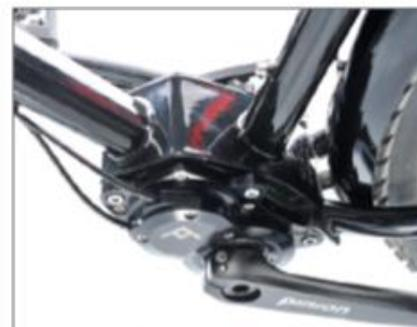
**Made by Rennstahl: spezieller Flansch für das Pinion-Getriebe.**
