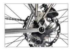
Die Bremsaufnahme ist zusätzlich abgestützt, um die Bremskräfte optimal aufnehmen zu können.
