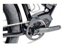
Shimano E-8000 Steps Mittelmotor mit 38er Kettenblatt und Führungsschiene.
