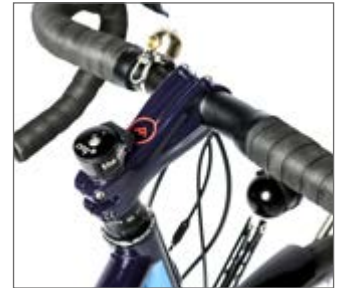
Das Cockpit mit USB-Ladebuchse, Titan-Klingel und Top-Licht.
