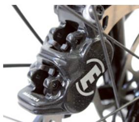
*Beste Bremsen im Testfeld: Vier Kolben im Bremssattel pressen die Beläge kraftvoll auf die Scheibe.*
