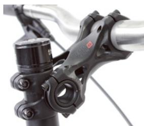
*Komfort-Testsieger Rennstahl: Der leicht flexende Titanlenker schont die Hände und kann in der Höhe verstellt werden.*
