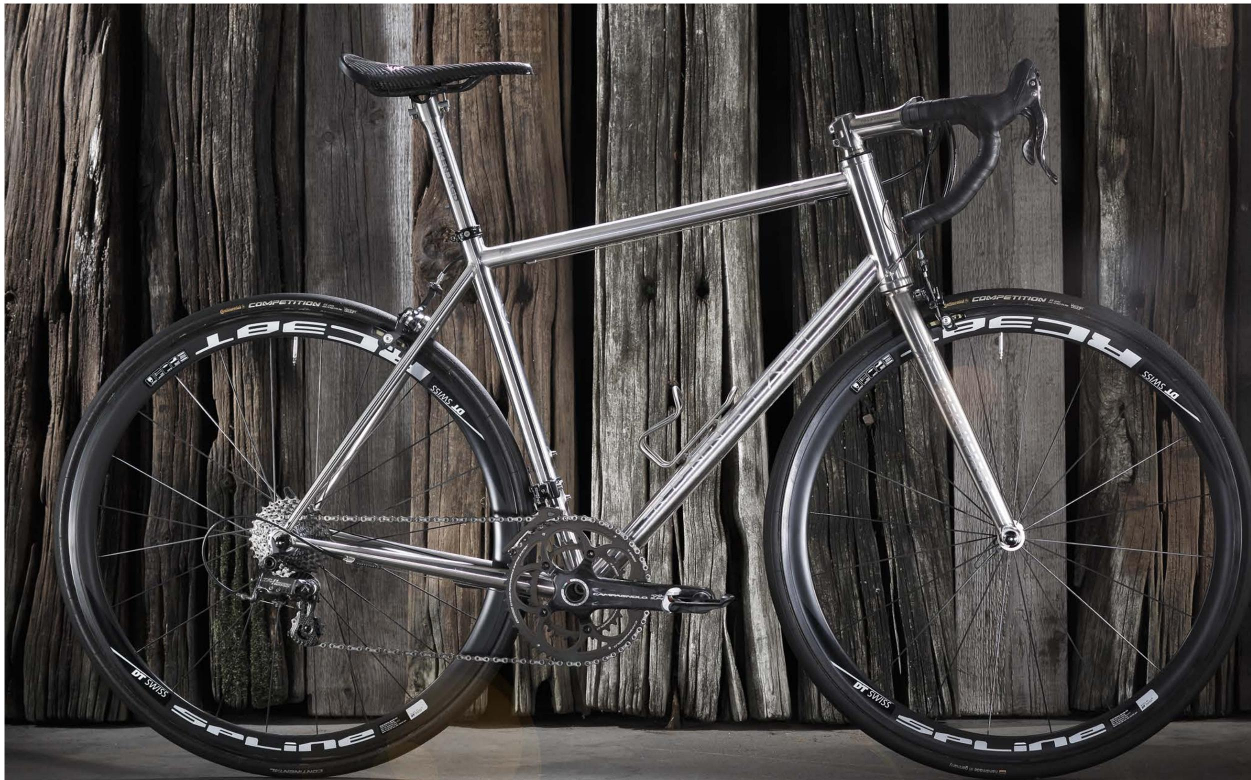
**Edel:** Der rostfreie Edelstahl-Rohrsatz Reynolds 931 wird handgebürstet, Schriftzüge und Logos sind sandgestrahlt.
